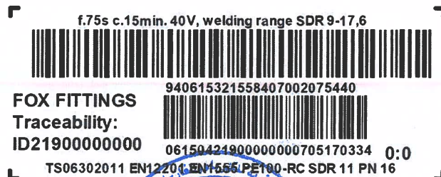
Exemple de marquage d'une selle té de branchement à emboitures électrosoudables
