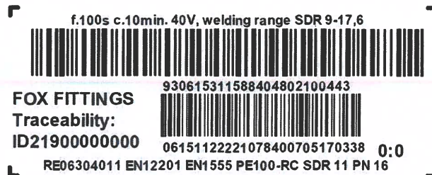
Exemple de marquage d'une réduction à emboitures électrosoudables
