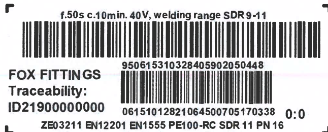
Exemple de marquage d'un bouchon à emboitures électrosoudables
