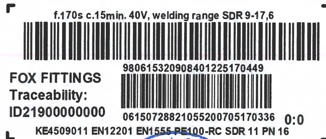
Exemple de marquage d'un coude 45° à emboitures électrosoudables
