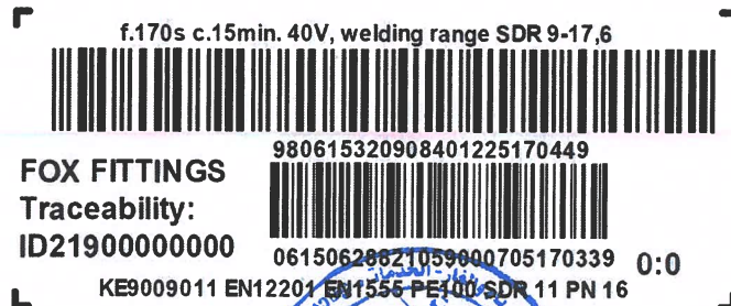
Exemple de marquage d'un coude 90° à emboitures électrosoudables
